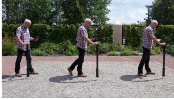
الشكل 7.7: مسح «متعرج» في وضع «3D Ground Scan»
