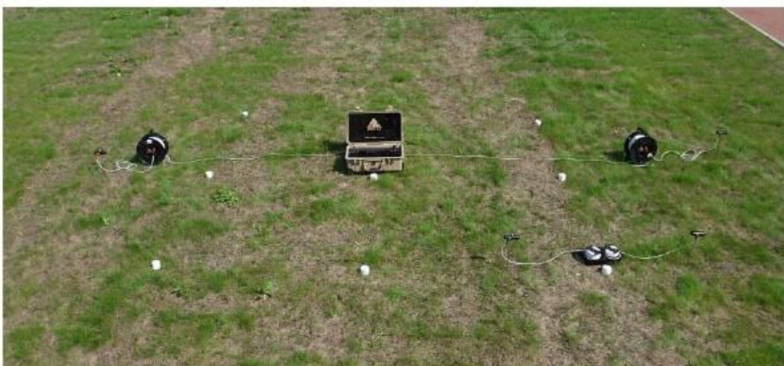
Figura 7.7: Disposición de los electrodos durante la exploración activa (rápido)
