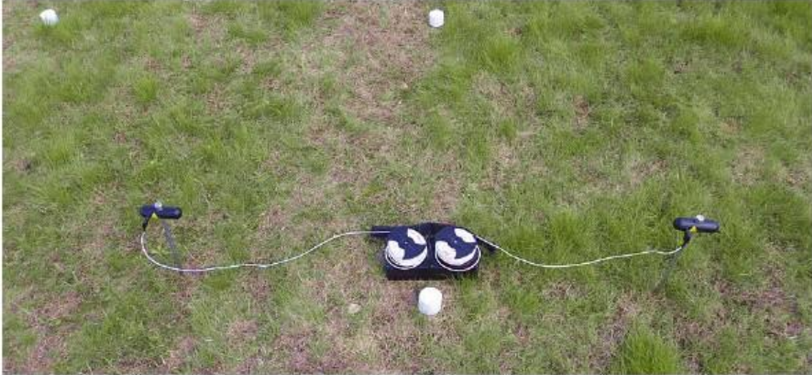
Figura 7.8: Disposición de los electrodos durante la exploración pasiva
