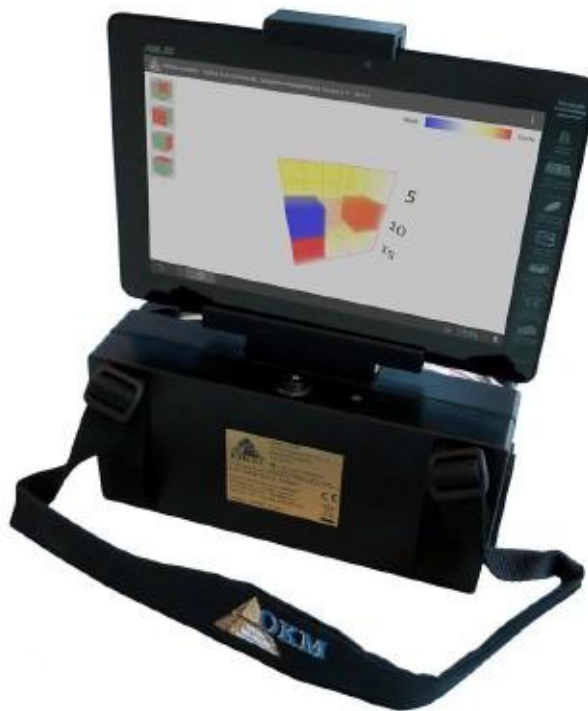
Figura 6.3: Tablet PC montado en Controlador
