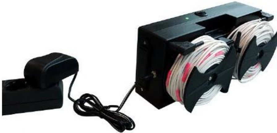
Figura 6.2: Conexión del cargador del Contralor
