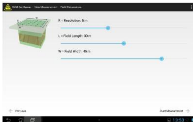
Figura 5.8: nueva medición - dimensiones de campo
