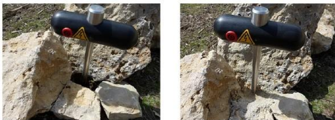
Figura 9.5: La perforación de un agujero y rellenarlo para el electrodo
